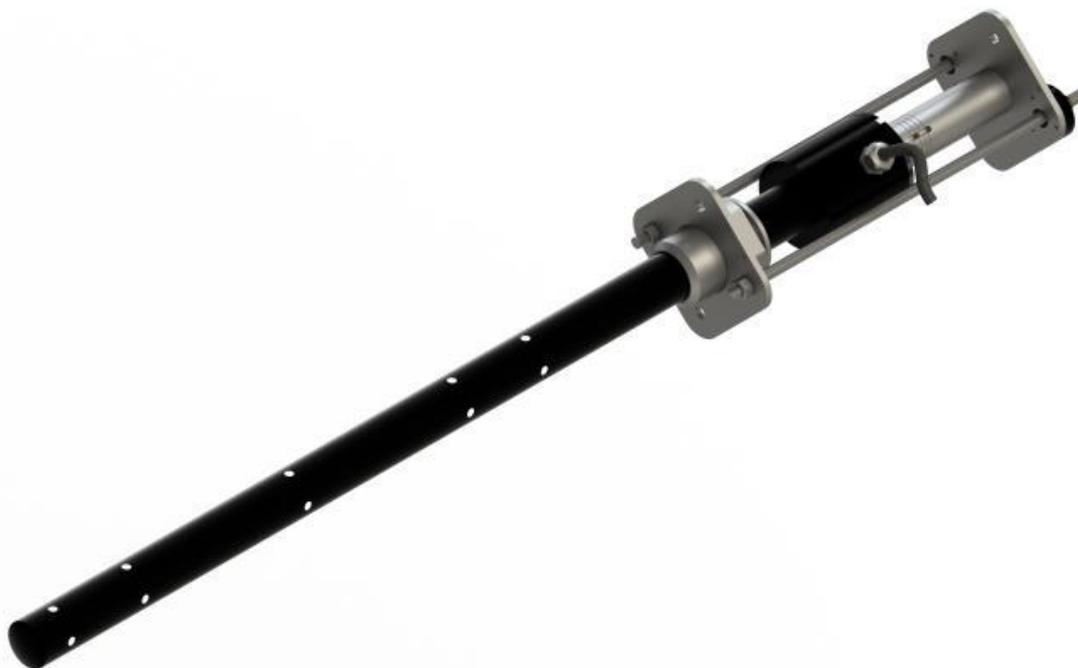
**AVI-MAG** este un debitmetru electromagnetic de insertie pentru masurarea debitului mediu pe conducta. Pentru acest lucru el este dotat cu seturi de electrozi montati pe toata lungimea senzorului, la distante egale, pentru a masura si transmite media curgerii pe intreg diametrul conductei. Designul specific cu mai multi electrozi compenseaza profilele de curgere variabile, inclusiv in conditii turbulente de curgere.
